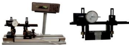
Настройка прибора НИИК-100/01У с помощью прибора НИИК-20(слева) и по шаблону(справа)
